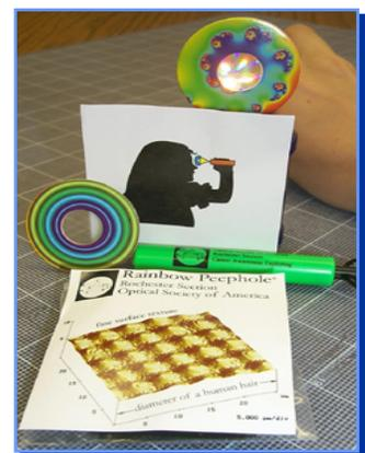
举起主题包，从正面展示图片。向学生描述这是窥视孔中透明塑料一侧表面的高度放大照片。它是用一种称作原子力显微镜的仪器拍摄的。[光学工程师和物理学家发明了这样的仪器。]注意：刻度为微米，人的头发粗细为 30 到 80 微米，塑料的横切面具有有规则的小凸块排列，只是因为这些小凸块高度仅为 2 微米，无法看到或感觉到。凸块互相紧密挨着，大约 50 个凸块才能容纳一根头发。向学生说明，这些凸块造成白光根据窥视孔的彩色折射到窥视孔中。这种线程称作“衍射”。指出有规则凸块排列和通过窥视孔看到的图案之间的相似性。向学生说明电信和互联网使用光纤、激光和称作“衍射光栅”的窥视孔，将光线从一个光点分成许多个每个都具有不同彩色的光点，为实验划上句号。这点是全世界同时进行无数次通话的关键所在。该领域的人们从事“光子学”工作。要求学生将手电筒和窥视孔密封到其主题包中。提醒学生可以自己保存主题包。向学生提议向家人揭示通过衍射用白光看到彩色的秘密。严禁直接朝着太阳光用窥视孔观看！
