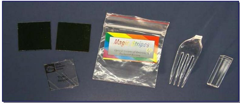
如果您能够使用悬挂的投影仪并使教室光线变暗，则可以将大极化器放置在悬挂的投影仪上，并展示极化器如何极化、传播和熄灭来自投影仪的白光。将交叉的极化器分开放置在四个角落，并使用**塑料杯**制作一个**偏光镜**。将“手提箱”中的**塑料银器**放置在偏光镜中，后退站立，并享受激动人心的一刻。询问彩色的来源。[您可能会得到一些正确的回答。]向学生解释：透明材料内部的应力会降低穿过偏光镜的线性极化光的质量，导致各种彩色的出现。借助偏光镜，地理学家可以识别某些水晶和矿物的结构。土木建筑工程师会检查用透明塑料制成的桥梁模型内部的应力，以理解如何建造出更坚固的桥梁。光子学技术人员也借助偏光镜来评估激光玻璃和激光水晶的质量。
